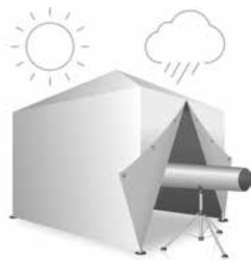
Abbildung C.1: Vorbereitung des Schweißplatzes nach DVS
